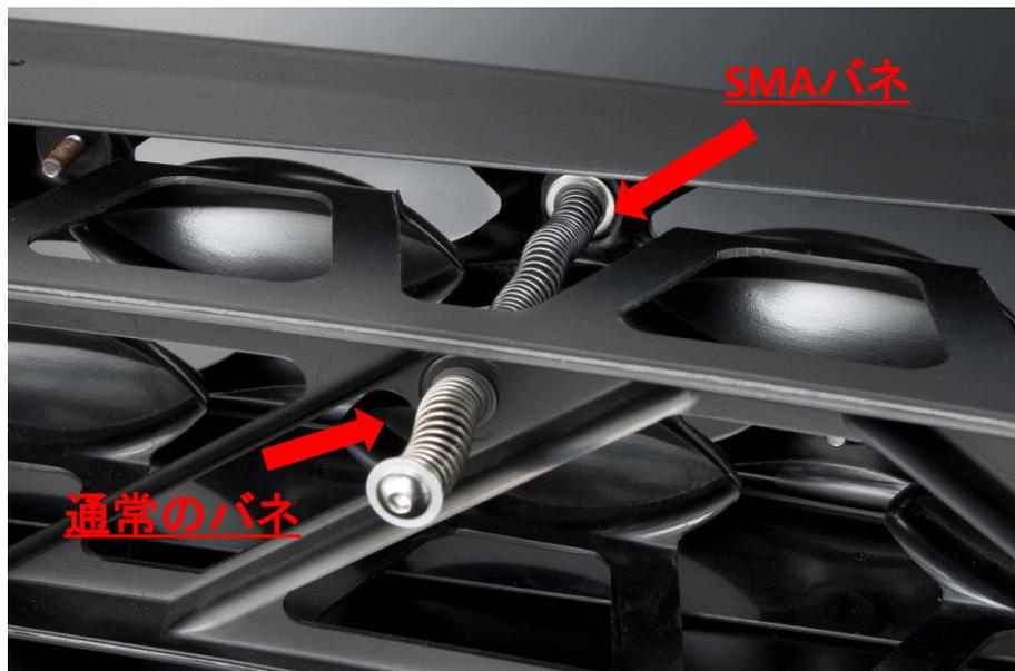
本品は独自研究開発したSMAバネが約30°C(全開)~約8°C(全閉)と気温を感知する温度センサーの役割と記憶された温度で形状変化する力を動力源として、完全にグリルの自動開閉制御を行います。これによってエンジンルーム内の冷えすぎを抑えて、吸気温度をエンジンの理想の燃焼に近づけて、熱効率向上による無駄なアクセルの踏み込みやエンジン作動時間を減らすことで燃費改善をはかるパーツです。またこれによりヒーターの効率も改善され効き出す時間も短縮できます。また、SMAバネで自動開閉制御をしますので面倒な電気配線、モーター、センサーなどは必要としません。当社はこの技術で国際特許を取得しております。
