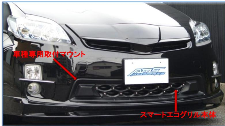
一般的にバンパー開口部からエンジンルームを抜けていく走行風は抵抗となり空力上悪影響となります。スマートエコグリルは専用の取付マウントとのコンビネーションによりバンパー開口部をフラットに近づけ走行風流入を制限することでCD値が向上し燃費改善を図ります。事実、海外自動車メーカーやレクサスGS、新型マジェスタ等に電動式のシャッター方式のグリルとして純正採用されておりこれが理論上だけでなく実効果を示す。
