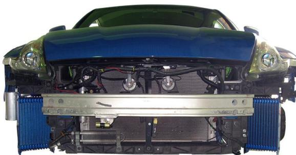
厳しい油温をカバーするため、ツインコア仕様を採用。コアは左右のフェンダーにセットし、ラジエターを塞がないレイアウトにしています。
